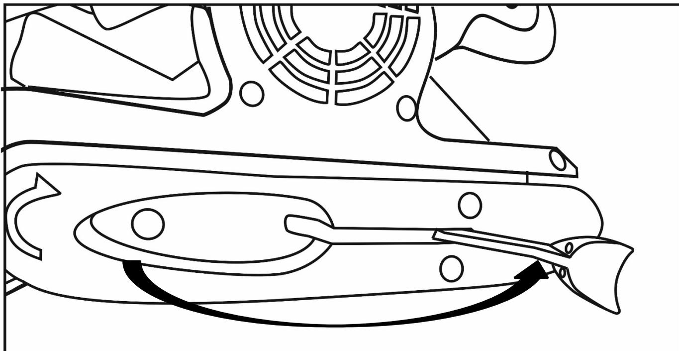
Рис.4 Рычаг натяжения ленты
